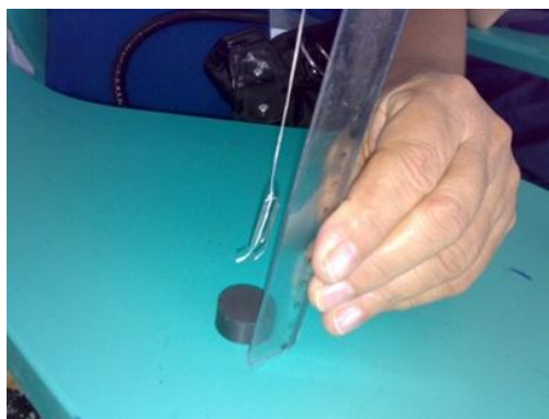
Figura 8 - medindo a distância da força de atração magnética
